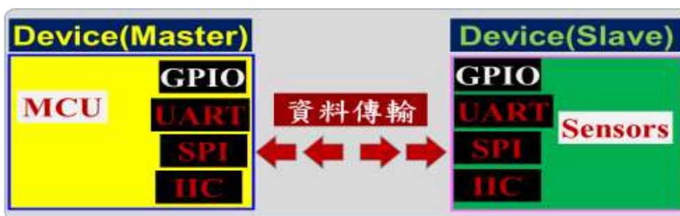
圖 1-4.1、[介面技術]課程內容微控制器與感測元件的資料傳輸架構圖
